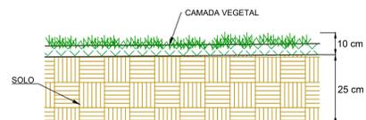
DETALHE 4 - ESCAVAÇÃO TRAVESSIA SEM ESCALA
