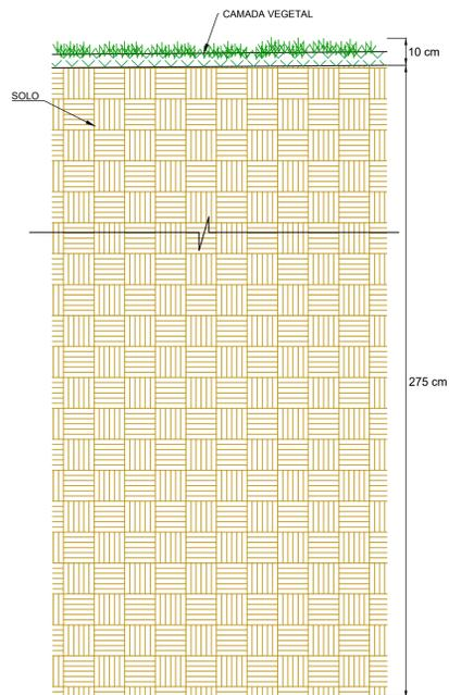
DETALHE 5 - REMOÇÃO DE CAMADA VEGETAL ACESSO SEM ESCALA
