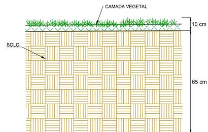
DETALHE 3 - REMOÇÃO DE CAMADA VEGETAL TIPO 02 SEM ESCALA
